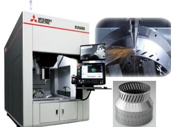
3次元細孔加工専用モデル
