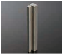
電極材 : φ0.2/BS 工作物 : SKD11, t60mm 面あらし : Rz3.5μm/Ra0.45μm
