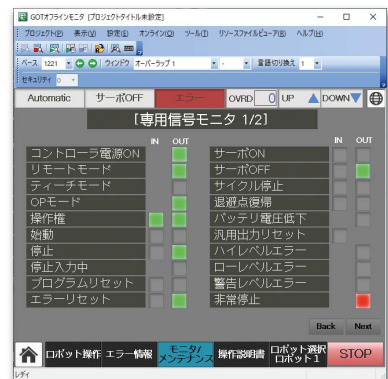
アラーム発生時の状態
