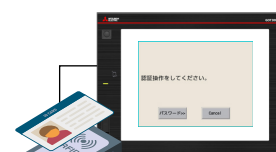
RFIDリーダによる外部認証機器によるログイン
