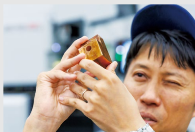
MVでは鉄に素材が限られていたMaisart®ノズル離れ制御を、MGでは銅などにも拡大し、ミクロン単位で制御した。
