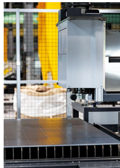
アームに取り付けられた印字装置によって、鋼板の加工前に自動でマーキングされる。
