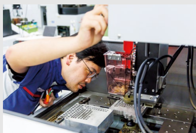
適切なメンテナンスが実施されていない状況でも高確率でワイヤの自動結線が実施可能な機構を岡田は開発した。
