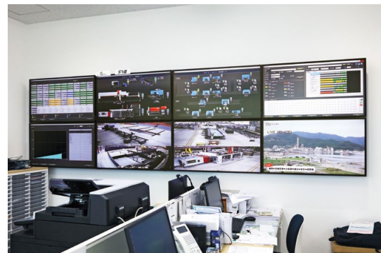
SA1-III +ISQbicを活用することで、工場にある加工機の稼働状況を事務所にある液晶モニターから確認可能。
