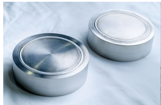
電子ビーム溶接を行ったサンプル品。丸く色が変わったところが溶接箇所。材質は一般構造用鋼材のSS材。内部に銅を真空封入している
