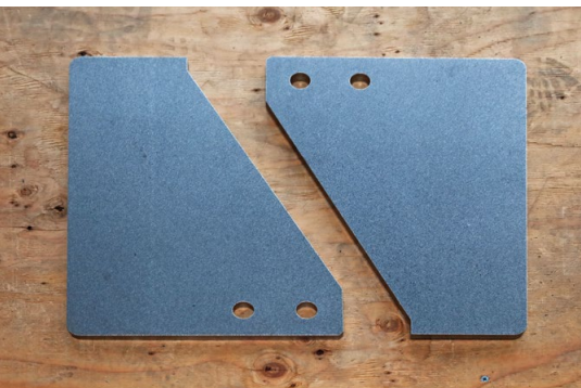
建築用のH形鋼などを接合するためのガセットプレート。そのサイズや形状に合わせてレーザ加工機で切断や穴明けを行う。
