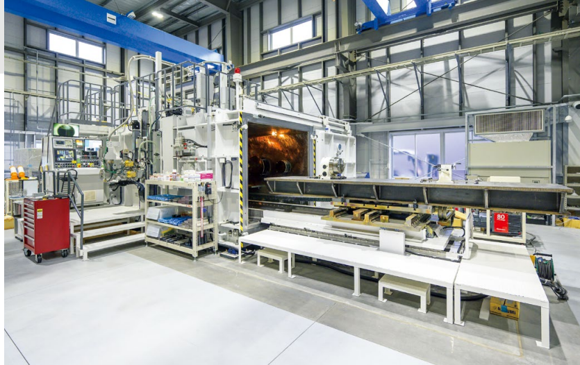
三菱電機の電子ビーム加工機EBM-30L/HB-1VHL/R-G26型。中央に見えるのがチャンバー。そこから右へと伸びているのがテーブル。X軸(左右)、Y軸(前後)が同期して動く。テーブルには治具がセットされる。
