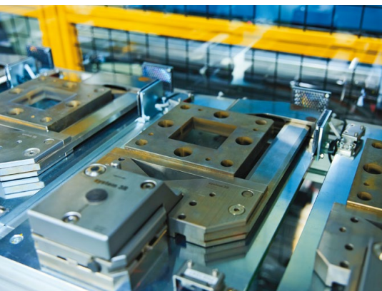
ワイヤ放電加工機MP1200で加工するために治具にセットされたワーク。ワークが最大8個置ける棚からロボットアームがつかんでMP1200に運ぶ。
