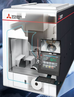
DED方式(Directed Energy Deposition) ワイヤ・レーザ金属3Dプリンタ
