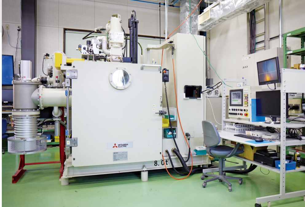
2022年に導入したチャンバーサイズ1000×1000×1000mmの4号機。電子ビーム出力は最大6kW。移動ストロークは500×400mm。
