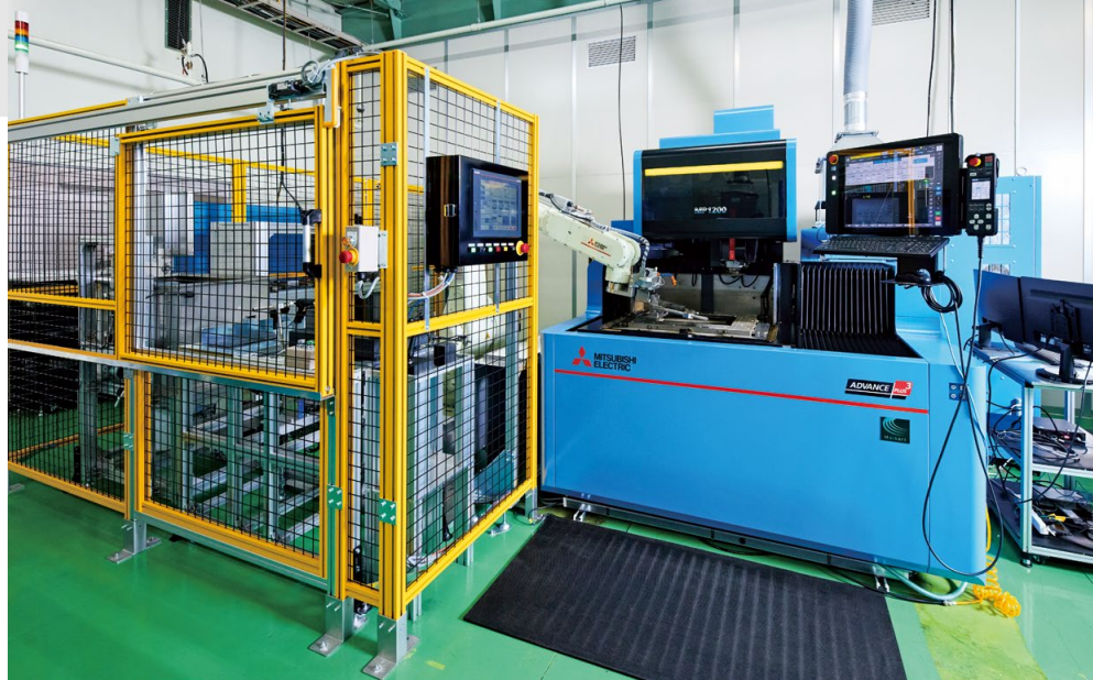
ワイヤ放電加工機MP1200(右)、柵の向こう側にはロボットとワークのストック棚がある。
