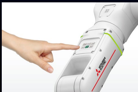
MELFA ASSISTAを簡単に動作指示できる操作ボタンをロボットアームの上部に装備
