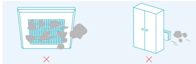
換気扇に汚れが詰まっていますか？
