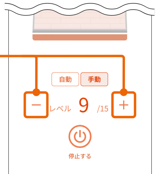
床暖房の温度設定がレベル切り換えタイプの場合
