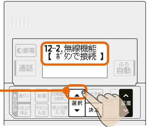
**7** 給湯温度スイッチ  $\blacktriangledown$  で「ホッパで接続」を選び **決定** を押す
