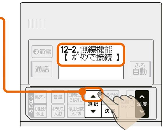
**6** 給湯温度スイッチ **▼** で「スマートフォンで接続」を選び **決定** を押す
