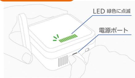
電源が入り、環境センサーのLEDが緑色にゆっくり点滅（1秒間隔）するのを確認できたら画面下部の環境センサーに接続するボタンをタップして下さい。
