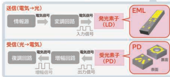
次世代データセンター向け 「200Gbps EMLチップ」 「200Gbps pin-PDチップ(表面/裏面)」
