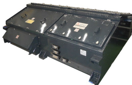
屋根上強制風冷式推進制御装置（実機）
