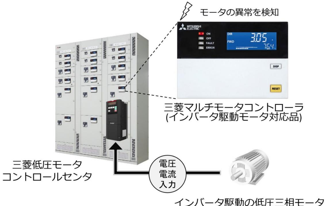
「三菱モータ診断機能付マルチモータコントローラ」インバータ駆動モータ対応品の適用イメージ
