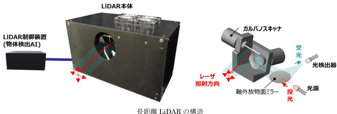
長距離 LiDAR の構造
