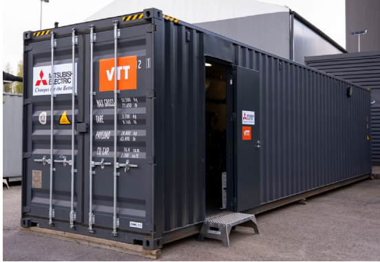
海水を介し大気中から CO 2 を回収する技術の実証機
