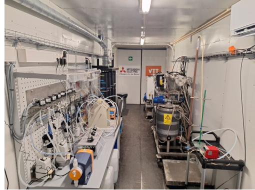
海水を介し大気中から CO 2 を回収する技術の実証機
