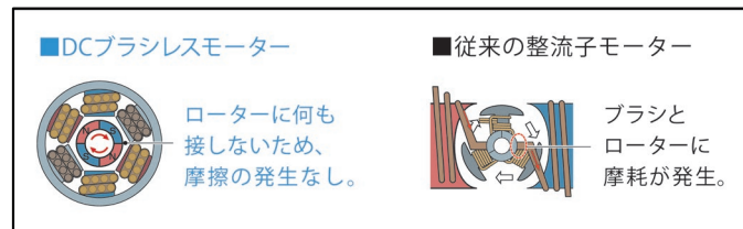
DC ブラシレスモーター・整流子モーターの比較イメージ
