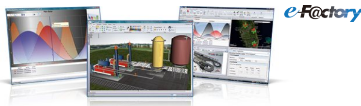
三菱電機 SCADA ソフトウェア「MC Works64」の監視・制御画面
