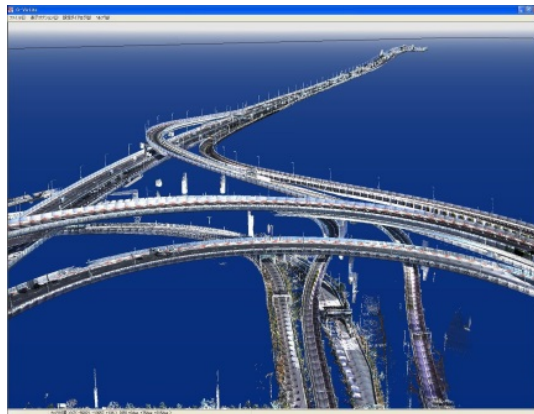
事例 2：高速道路 標準レーザー点群のカラー化で立体交差を表示
