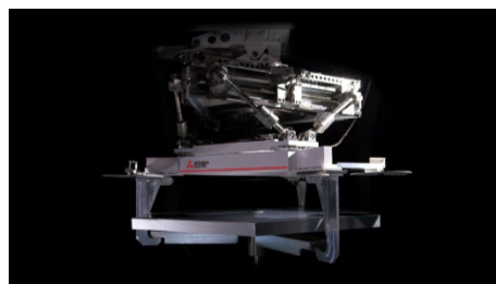
次世代超大型望遠鏡 TMT® 向け分割鏡交換ロボット
