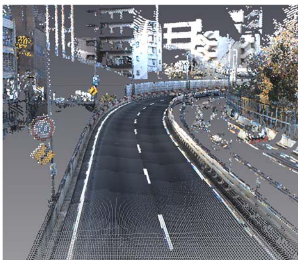
MMS で取得した 3 次元空間位置データ (レーザ点群)
