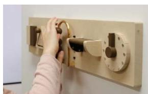
「触りたくなるインターフェース」コンセプトの提案として、視覚障がい者も健常者も直感的に操作できるリモコンを、空調機器を例にして盲学校と共同で試作しました。操作する項目ごとに操作部の形状や動きを変えて、設定状態をわかりやすくしているので、リモコンなどの機器操作に不慣れな人でも直感的に操作することができます。
