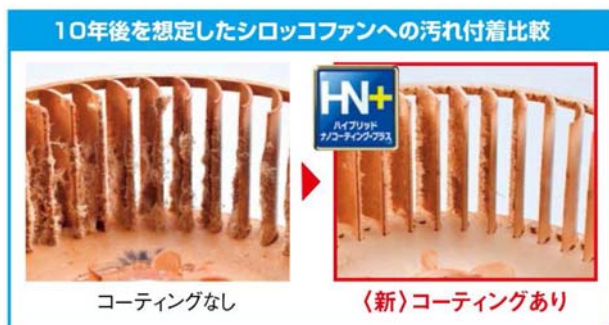
図 4. 10 年後を想定したシロッコファンへの汚れ付着比較 ※6
