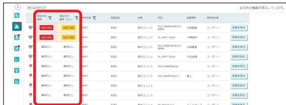
異常発生後、ユニット側で異常が解除されると異常発生状況画面の異常コードは自動的に非表示となります。異常プレはユニット側で解除できないため、履歴を見るをクリックして異常履歴画面に移動し[異常(プレ)を解除する]をクリックして解除する必要があります。(反映まで時間がかかることがあります)
