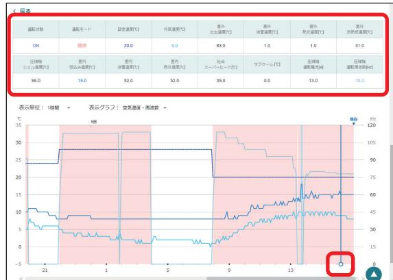
▼ 積算データの項目では、室内フィルター時間、圧縮機運転回数（100回単位）、圧縮機積算時間（5時間単位）を確認することができます。ここで表示している室内フィルター時間は、フィルタークリーニングサインリセットの操作をした後からの経過時間を表します。圧縮機運転回数、圧縮機積算時間は空調機が保存している累積のデータです。「保全の目安を確認する」のリセット機能でリセットすることはできません。
