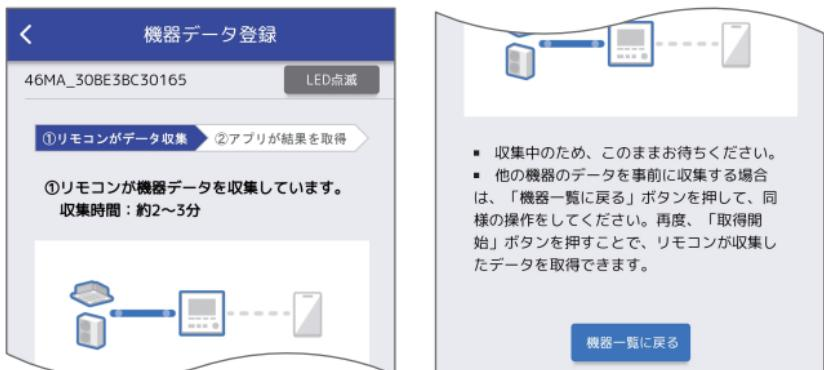
▼ PAR-45MA 以降のリモコンから運転データを取得する場合、リモコンや MELflo の操作で事前に収集した運転データを取得することができます。リモコンでの運転データ事前収集方法については、リモコンの取扱説明書をご確認ください。
