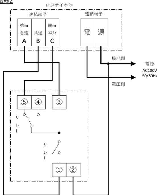
結線図：結線パターン3 ※3ノッチ（強・中・弱）のうちいずれか2ノッチ（＜強-中＞,＜中-弱＞,＜強-弱＞）を選択下さい。3ノッチ（強-中-弱）での使用はできません。
