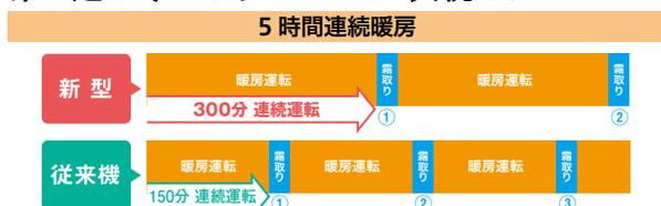
\*従来機PUZ-ZRMP-KA8/ZRP-KA13と新型機PUZ-ZRMP-KA12/KA2との比較。当社試験室 (外気温  $-15^{\circ}\text{C}$ ) での最大運転時間。外気温条件により、連続運転時間は異なります。
