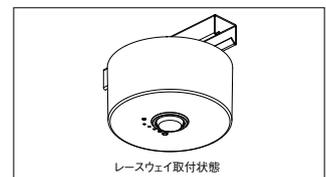
直付形Φ150タイプは電源穴から配線を引き込んで端子台に差込む構造。配線スペースが少ないレースウェイにも露出ボックスなしで取付可能です。
