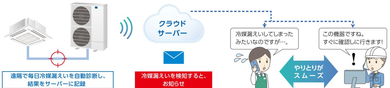
フロン排出抑制法で定められた簡易点検をサポートし、フロン点検の手間を削減
