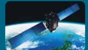
準天頂衛星初号機「みちびき」 高精度な測位情報を送り、 エコ経路ナビなどに貢献
