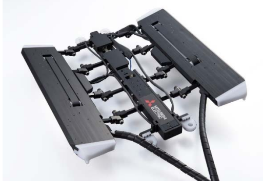
発電機用薄型点検ロボットの外観
