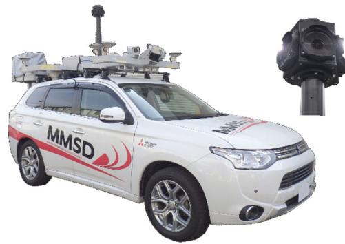
360°カメラを搭載した計測システム (MMSDⅠ) (車両全景と360°カメラ)
