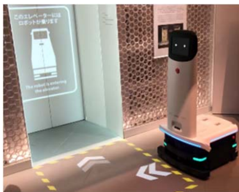
ロボットがエレベーターに乗り込む様子
