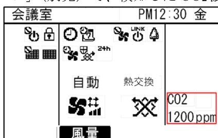
図3 「ジーニアスリモコン」の CO 2 濃度表示画面例
