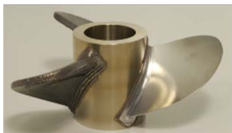
Φ300の船舶用プロペラ製作例 加工時間と廃棄材料を約80%削減
