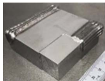
補修を想定した肉盛溶接例
