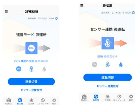
図3 換気機器の運転状況画面イメージ
