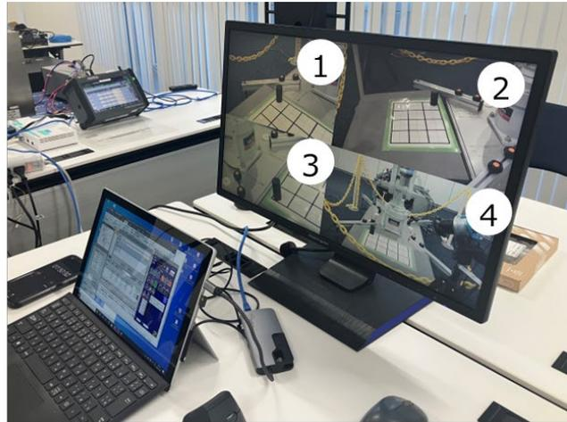
ロボット制御用パソコンと遠隔操作モニタ
