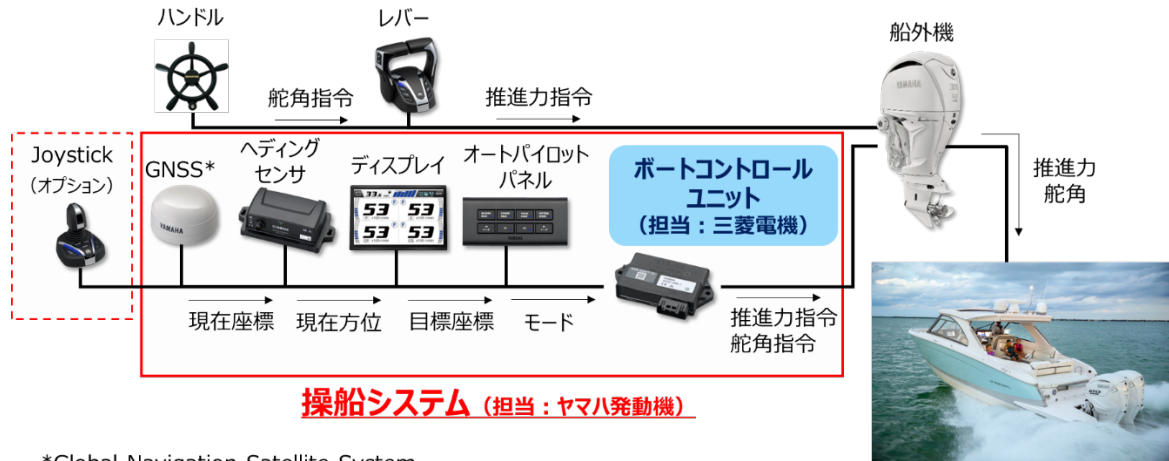
共同開発した操船システムの構成
