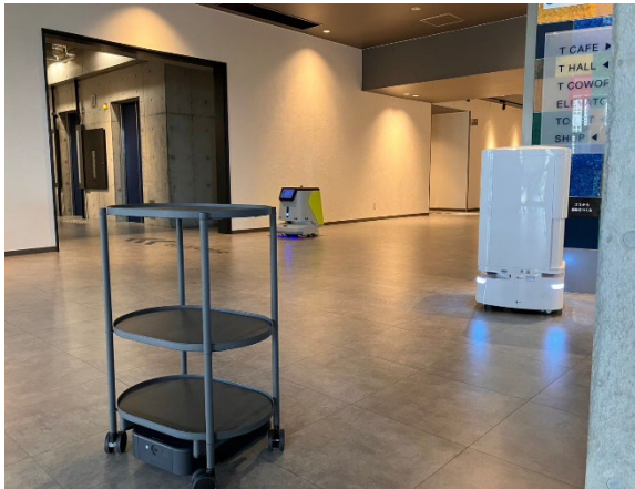
複数メーカーのロボットが群管理により交差点を スムーズに通行する様子
