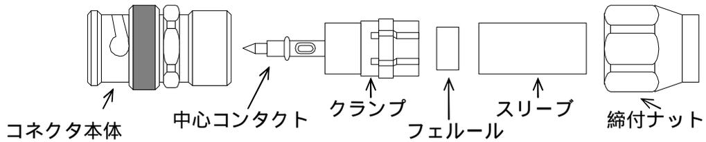
ケーブルに締付ナットを挿入した後、ケーブルの先端より下表の寸法で被服、シールド線を切り取ります。
