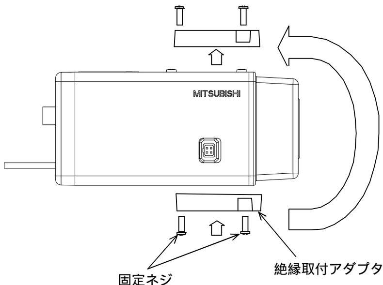
カメラの底面に取り付けられている絶縁取付アダプタを固定している固定ネジ（3個）をはずし、ネジを元に戻します。
