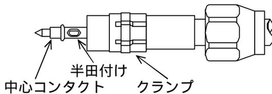
コネクタ本体を挿入した後、締付ナットを一杯にネジ込みます。
