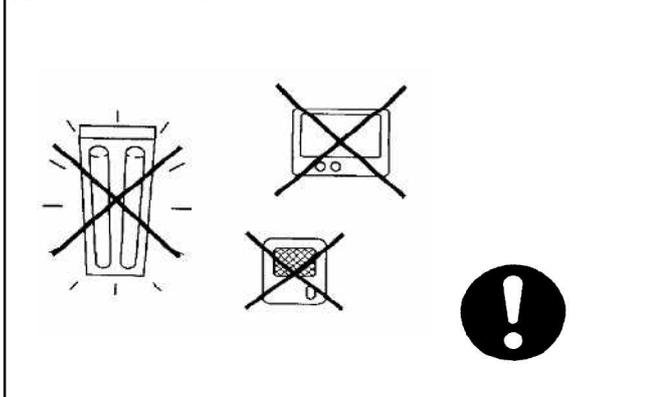
テレビやラジオの送信アンテナ、モータやトランスなどの強い電界、磁界の近くでお使いになると、雑音が入ったり映像が曲がったりすることがあります。このような場合は、カメラケーブルに薄鋼電線管を設けて通電してください。
