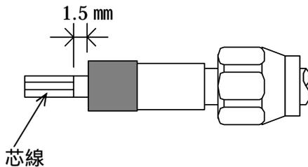
クランプにケーブルを挿入した後、中心導体と中心コンタクトを半田付けします。
