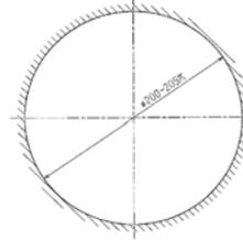
取付け面加工寸法図
