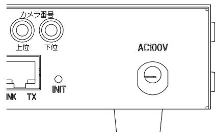
(2)上位 4bit、下位 4bit の組み合わせ(16 進数)により、カメラ番号=1~254 (ロータリースイッチ設定 : 00h ~FDh) を設定します。
