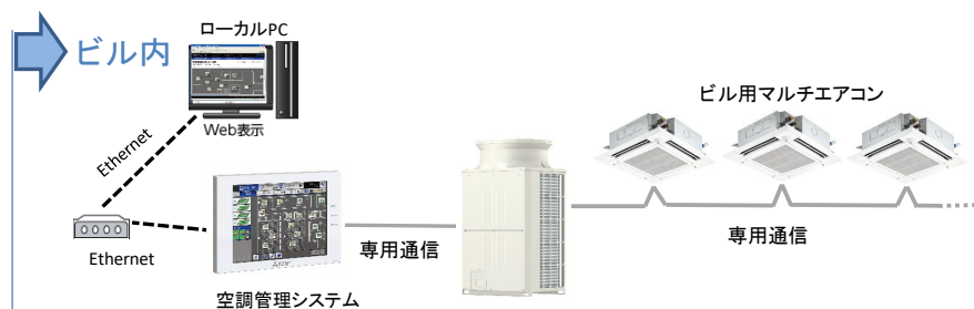
図 1 システム構成例 1 空調管理システムをビル内のネットワークで使用している構成
