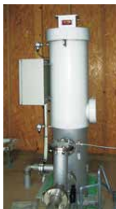
▲ 排オゾン分解塔
