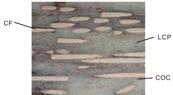
CF-LCP / COC試料断面の顕微鏡写真
