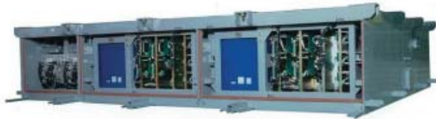
(a) 水冷主変換装置の外観
