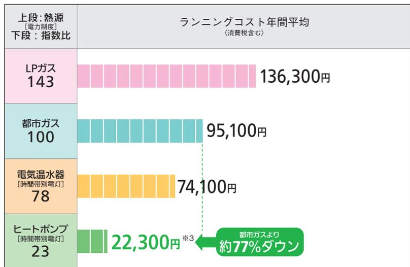
\*給湯保温負荷はJIS C 9220に基づく年間給湯保温負荷相当の使用湯量にて算出。
